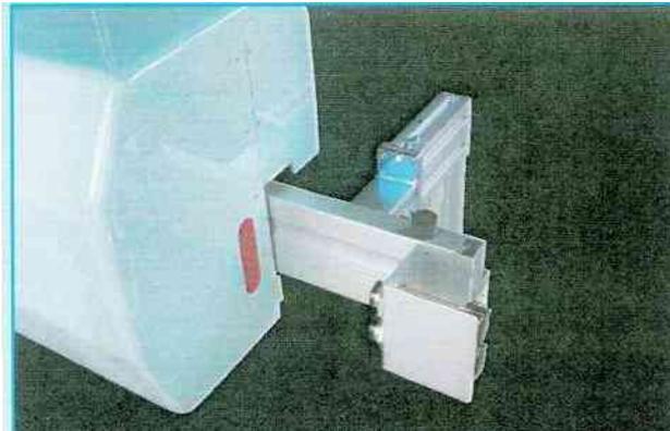
**Trasmissione dati i/o con infrarossi logici IR**
