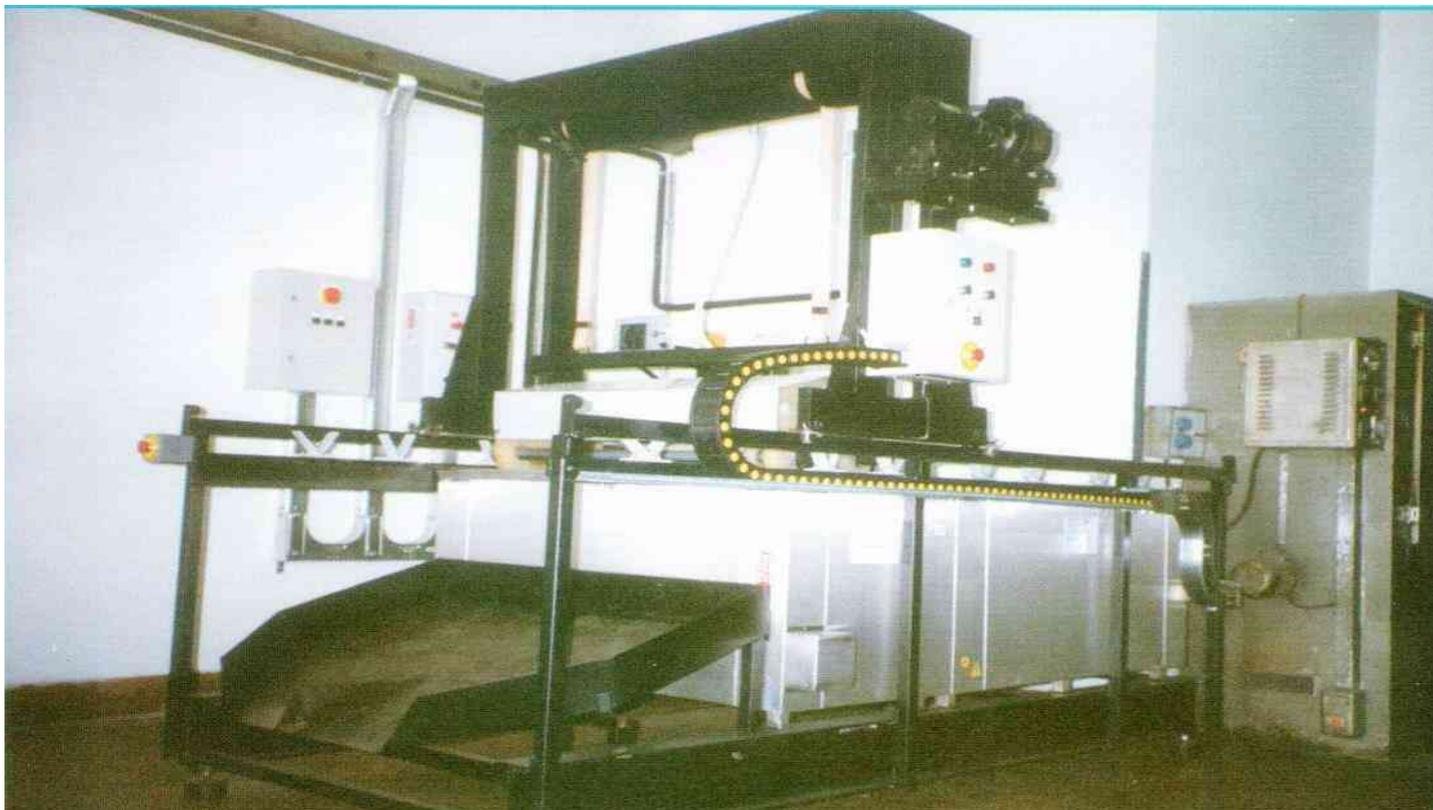
**Unità di lavaggio ad ultrasuoni a detergenti acquosi biodegradabili con doppio risciacquo rotante per il trattamento in continuo di articoli metallici di precisione in ottone, acciaio e bronzo per gas, idraulica ed elettronica per gas combustibile. Modello 3 AC 220. Impianto di lavaggio pezzi automotive in lega leggera e titanio completo di robot di traslazione e sollevamento automatizzato dei cestelli porta pezzi.**
