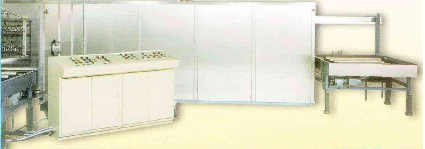
**Tastiera di programmazione digitale che permette, tramite il posizionamento assoluto, l'immediato auto-apprendimento di posizioni, soste, tempi, sbattimenti, inizio e fine ciclo, consensi e colloquio con PC, PLC, pompe, relè, allarmi, tappeti e rulliere di carico.**
